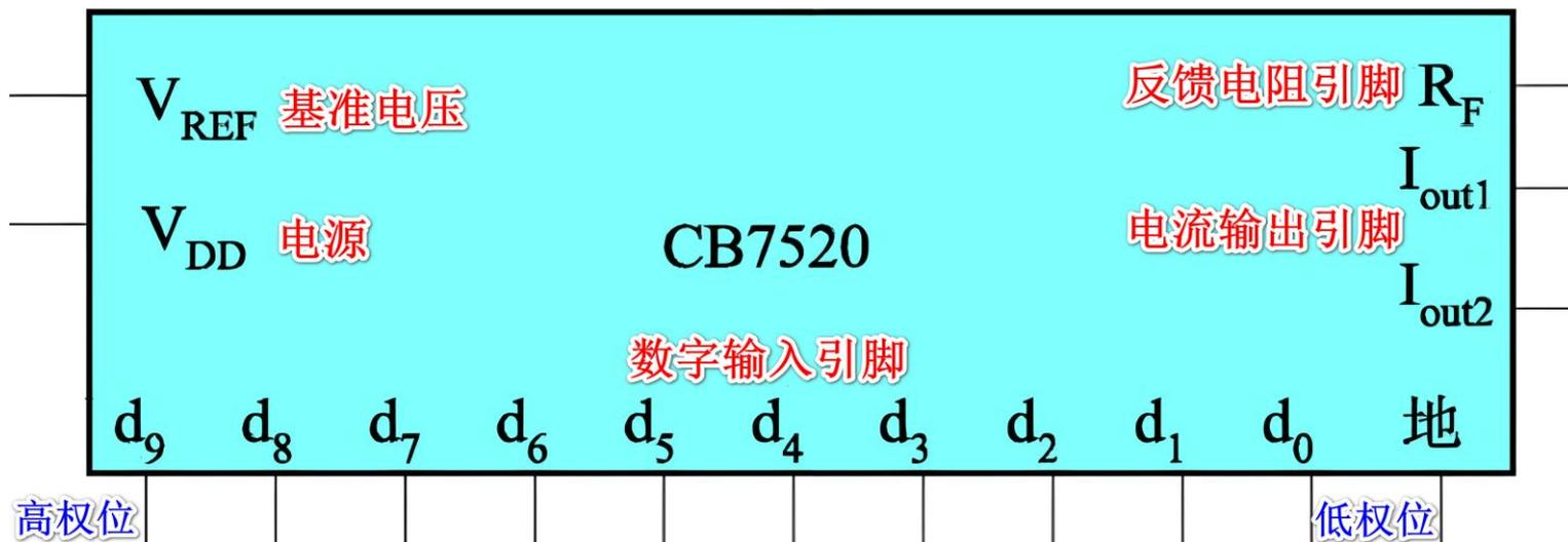
**例** 下图中，已知 CB7520 输出与输入的关系式  $v_O = -\frac{V_{REF}}{2^{10}} D$ ， $D$  为二进制数  $d_9d_8d_7d_6d_5d_4d_3d_2d_1d_0$ ，CP 的频率为 1Hz。要求：(1) 根据电路连接结构，写出输出  $v_O$  与计数器输出  $Q_3Q_2Q_1Q_0$  的关系表达式。 **例7-1**
