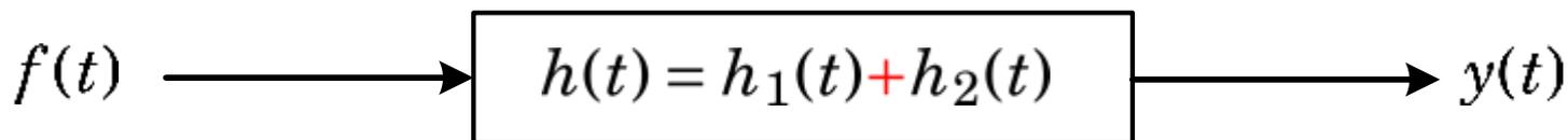
**意义：** 子系统**并联**后的冲激响应等于子系统冲激响应之**和**
